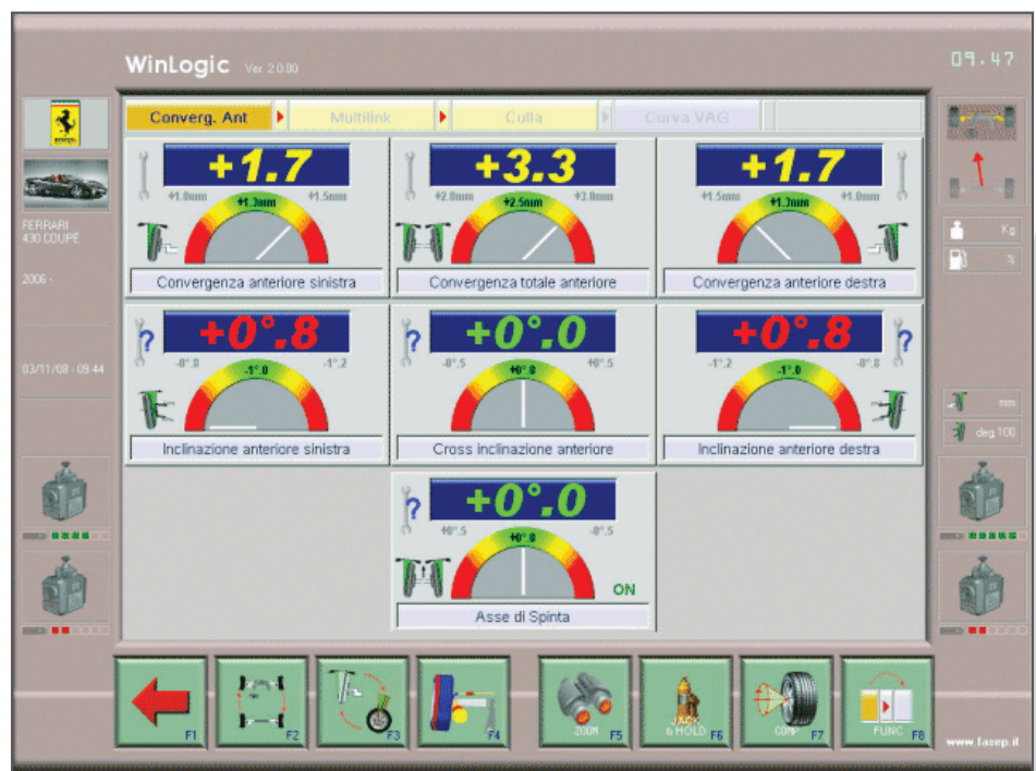
Regolazione convergenza anteriore Front wheel toe adjustment
