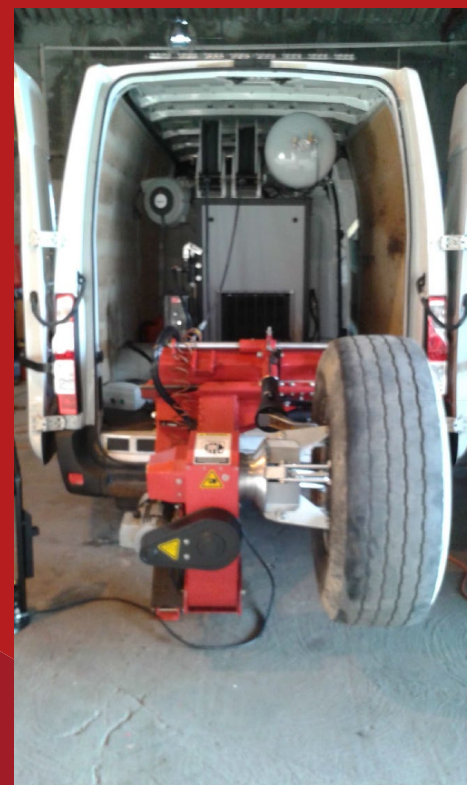
INSTALLAZIONE SULLA PORTA POSTERIORE CON MANDRINO INVERTITO
