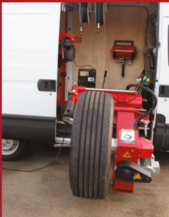
INSTALLAZIONE SULLA PORTA LATERALE
